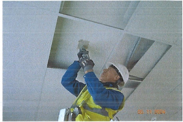
სურ. 16. რკ/ბ ფილის ბეტონის სიმტკიცის განსაზღვრა
