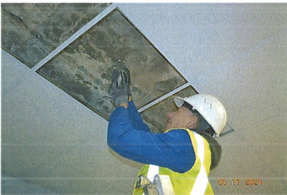
სურ. 41. რკბ ფილის ბეტონის სიმტკიცის განსაზღვრა
